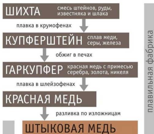
Рисунок 3. Этапы медеплавильного производства.
