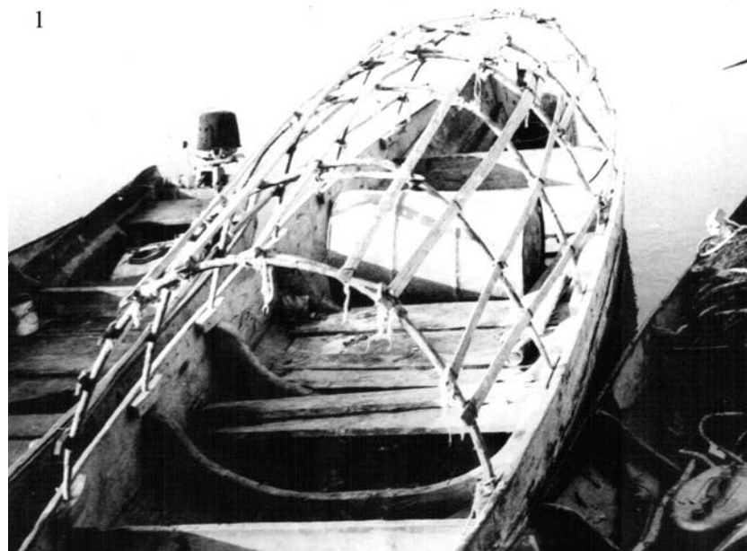
Рис. 66. Каркас крытой лодки: 1 – общий вид; 2 – нос лодки; 3 – способ соединения обручей; 4 – способ крепления обруча к борту и планок к обручу. 1974
