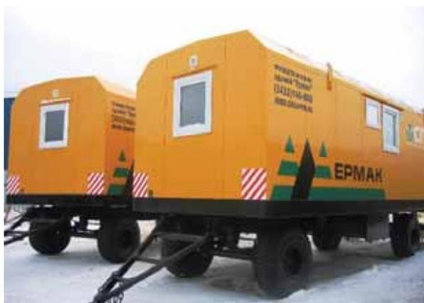
**Прим.** Вагон-дом (мобильное здание) — помещение, состоящее из блок-контейнера полной заводской готовности и предназначенное для проживания персонала во время работ. Может перемещаться с помощью транспорта, зачастую имеет собственное шасси.
