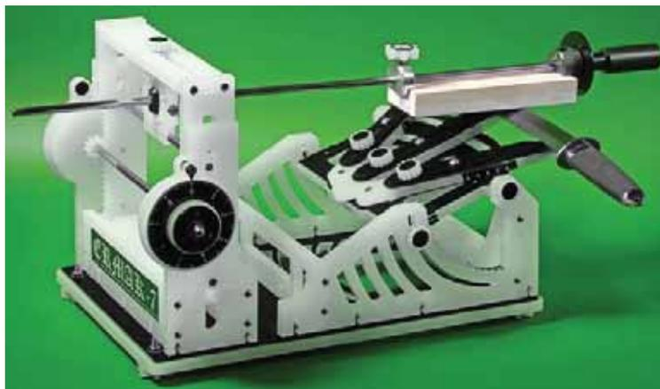
**Прим.** Станок для заточки — устройство, фиксирующее клинковый инструмент и абразив (точильный камень) под нужным углом. После настройки станка от человека требуется только двигать ручку из стороны в сторону, не уделяя внимания углу наклона.
