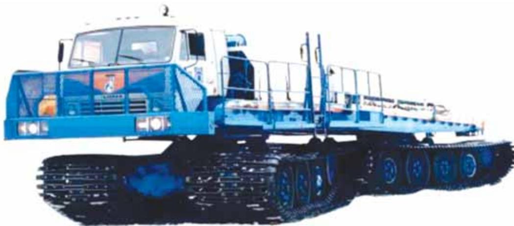
Тяжелый транспорт на базе специального гусеничного шасси, рассчитан на работу в условиях труднопроходимой местности и Крайнего Севера. Производится по заказу ОАО «Газпром» для строительства и обслуживания нефтепромышленного комплекса. За счет большой площади гусениц оказывает меньшее давление на грунт, чем взрослый человек. В конструкции использована кабина КамАЗа.
