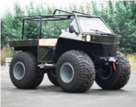
**Снегоболотоход «ЕРМАК»**, производится ЗАО СКБ «ГазСтройМашина» (г. Тюмень). Полноприводный вездеход для 2–3 человек, способен передвигаться вплавь. Выпускается также в более грузоподъемном варианте ЕРМАК-«Профи». Может комплектоваться плавающим прицепом того же конструкторского бюро.
