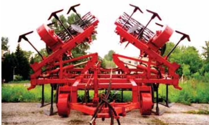
*Агрегат почвообрабатывающий комбинированный «ЕРМАК»* производится фирмой «Благовещенскагротехснаб» (г. Благовещенск). Прицепный. Предназначен для основной, предпосевной и осенней обработки и вспашки почвы, для культивации полей под зерновые и овощные культуры.
