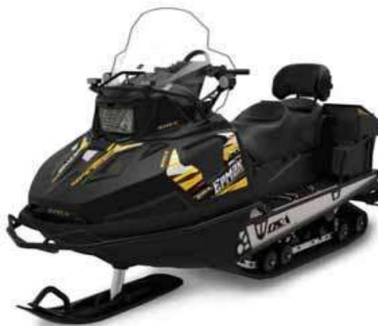
и 4-тактным, объемом 800 см<sup>3</sup>, с жидкостным охлаждением. Промышленное производство снегохода начнется в июле 2016 г.
