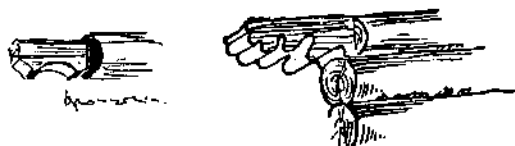
Рис. 45. Кронштейны («выпуски») кровель севернорусских домов
