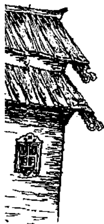
Рис. 44. Двухъярусная кровля алтарного прируба церкви в с. Самино. Вологодская область
