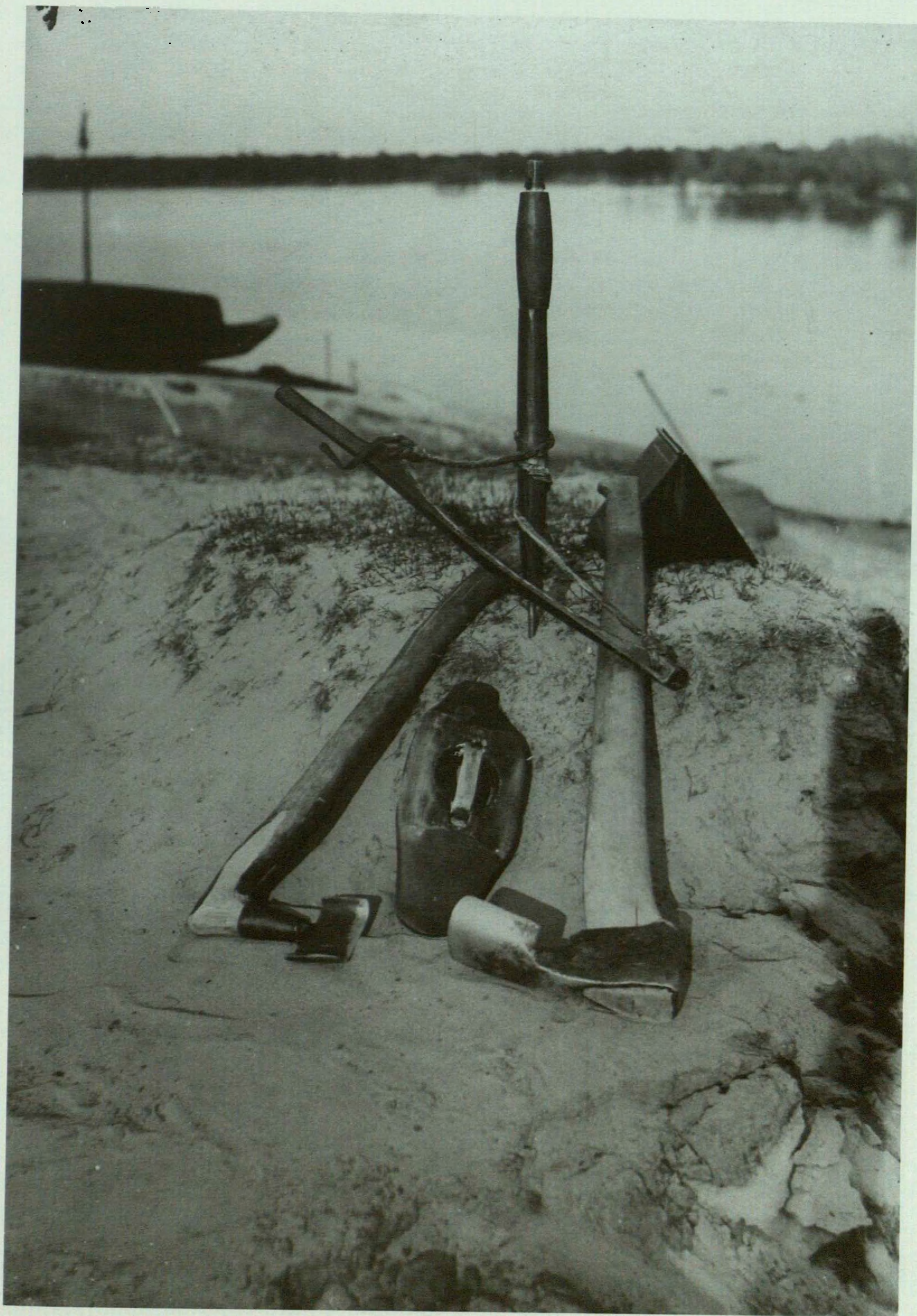
Фото 2. Инструменты для выделки обласов: кур, сугэл, струг, сверло.
