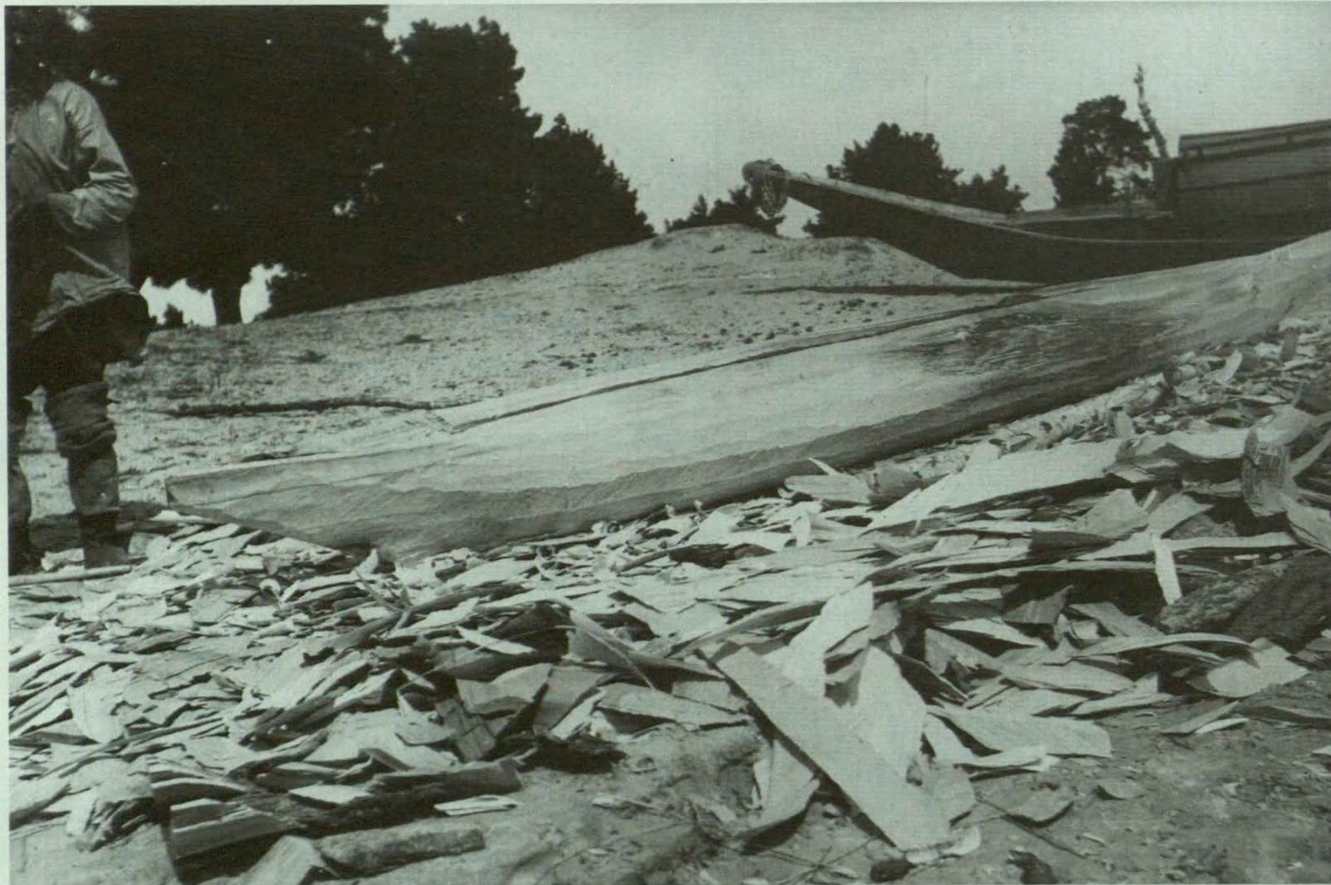
Фото 5. Отёсанный болванок обласа с выбранным сверху пазом и высеченными внутренностями кормы и носа.
