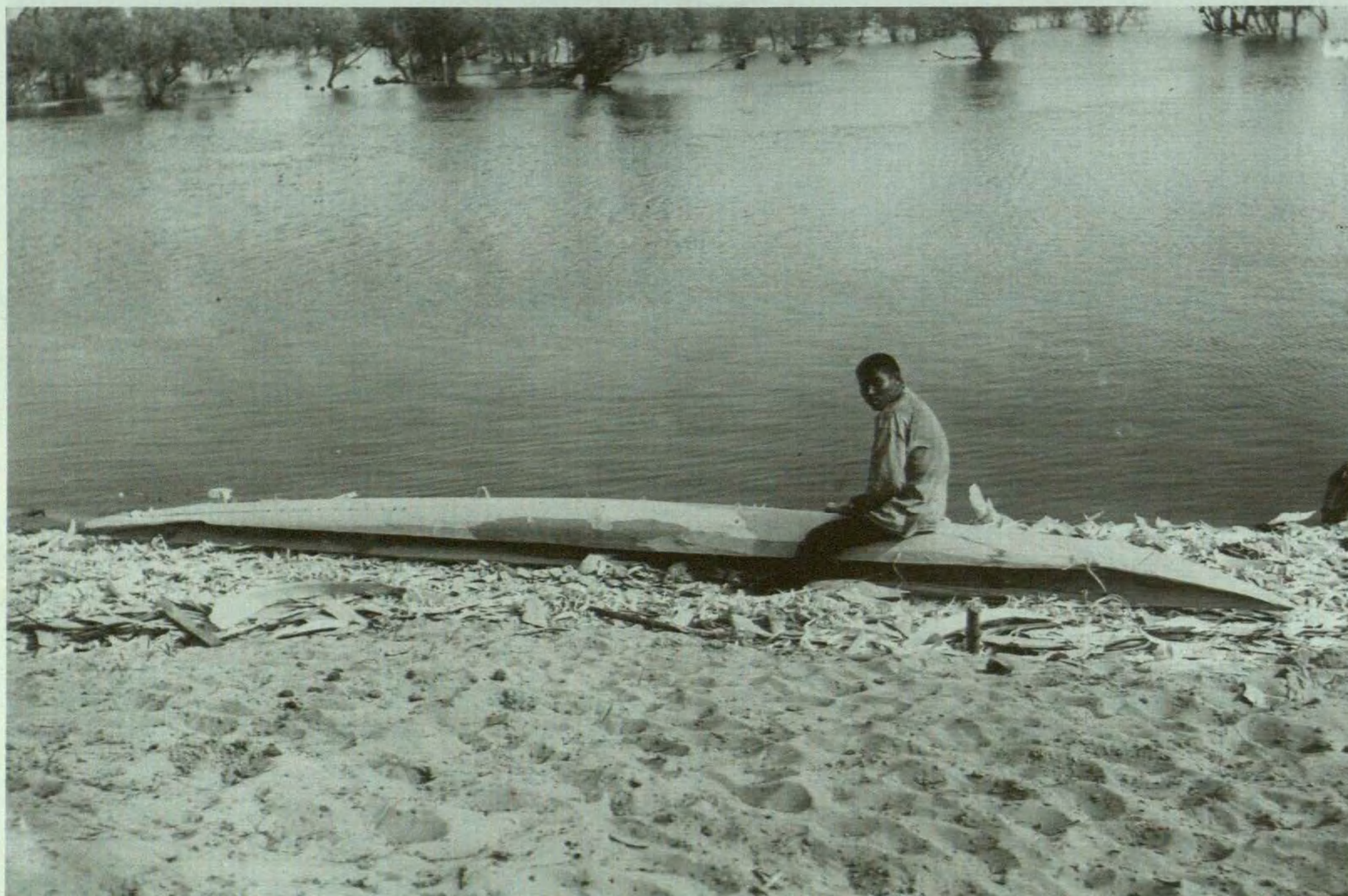
Фото 6. Острагивание стругом поверхности обласа.
