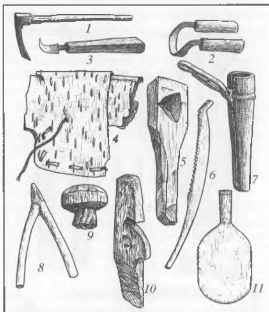
Орудия труда шорцев: 1 – тесло, 2 – стружок, 3 – нож, 4 – чехол для топора, 5 – колодка для литья свинца, 6 – кожемалка, 7 – ножны, 8 – распялка, 9 – инструмент для выделки горшков, 10 – колодка для правки чубуков, 11 – гончарная лопатка. Из фондов ОГОИЛМ
