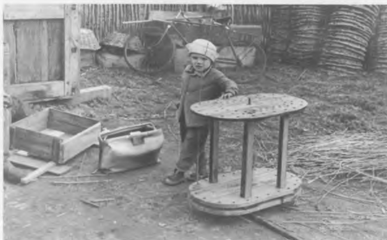
Станок для изготовления корзин томских татар. Д. Юрт-Оры Колыванского р-на Новосибирской обл. Фото Н.А. Томилова
