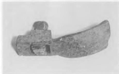
Тесло для долбления дерева при изготовлении лодок у сибирских татар
