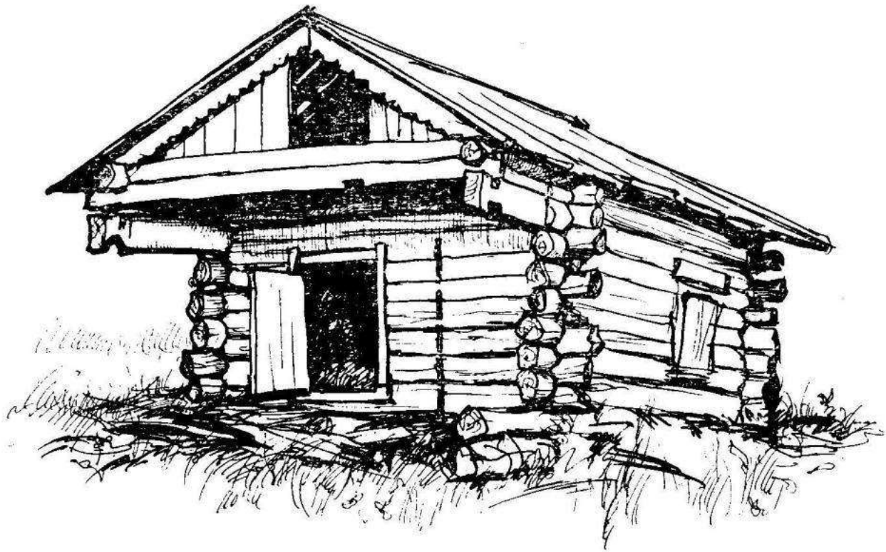
Рис. 8. Мансийский дом со стропильной конструкцией крыши и выносами.
